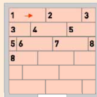
Schemat układania nr 1 – układanie do drzwi
