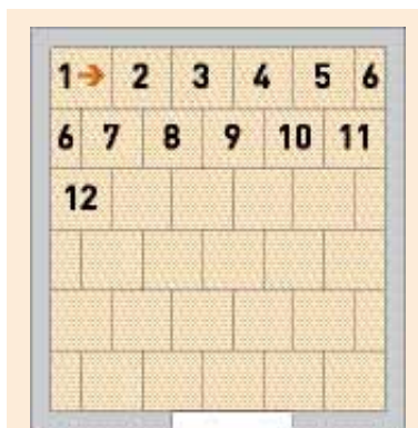
Schemat układania: układanie do drzwi
