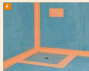
8 Przy zastosowaniu elementu odpływowego Powerpanel TE, w obszarach potąceń należy stosować system uszczelniający
