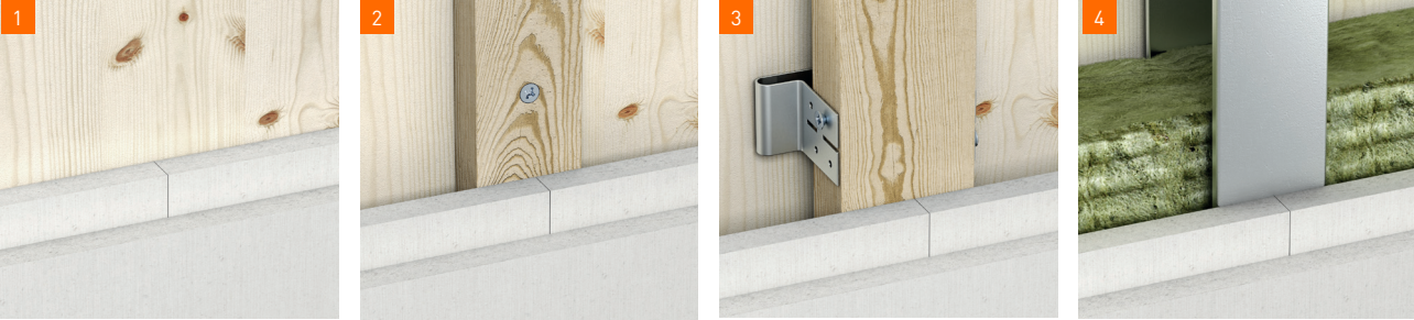
Bezpośrednia obudowa na drewnie masywnym/drewnie klejonym (alternatywnie płyty drewnopochodne)
