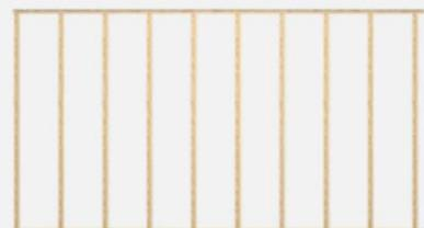
Rozstaw osiowy konstrukcji nośnej maks. 500 mm
