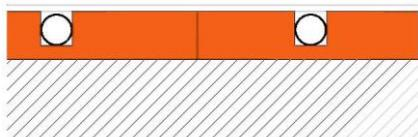
Produkt fermacell® Therm25™ należy przyklejać całopowierzchniowo na równe i nośne podłoże (wariant 3)
