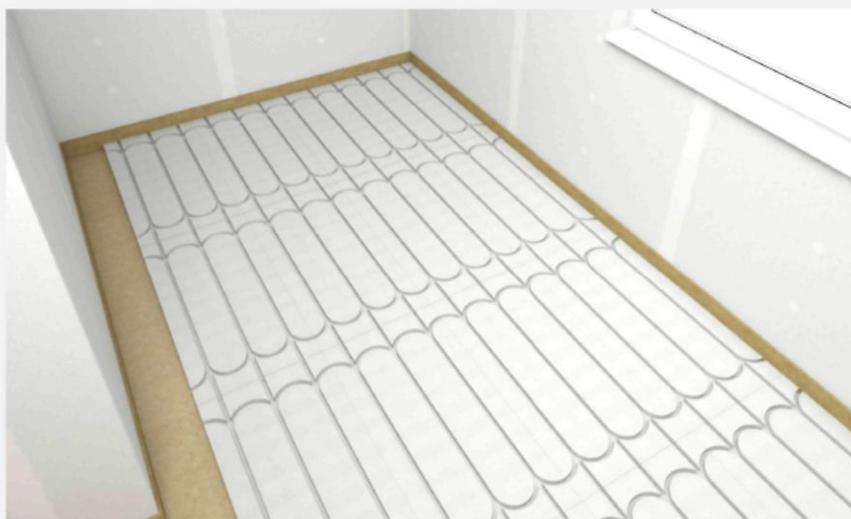
Po ułożeniu rur ogrzewania podłogowego, należy napętnić je wodą pod ciśnieniem, aby sprawdzić szczelność całej instalacji. Następnie należy zamontować dodatkową płytę gipsowo-włóknową fermacell® 10 mm. Warstwę tę układa się jednym ciągiem z przesunięciem spoiny  $y > 167$  mm do elementów fermacell® Therm25™.
