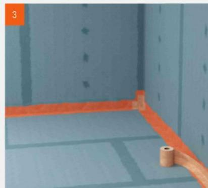
3 W świeżo fermacell™ Folię w płynie w obrębie naroży wcisnąć fermacell™ taśmę uszczelniającą oraz fermacell™ narożniki uszczelniające
